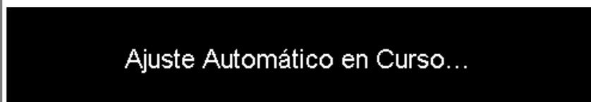
El elemento Ajuste automático permite al monitor ajustarse automáticamente a la señal de vídeo entrante. Después de usar el elemento Ajuste automático, puede seguir ajustando el monitor mediante los controles Reloj de píxeles (general) Fase (precisión) del menú **Configuración de visualización**.
