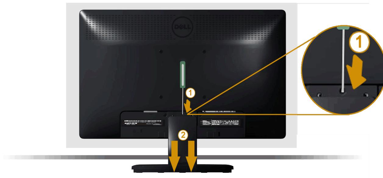
Después de colocar el panel del monitor sobre un paño suave, siga los pasos que se indican a continuación para extraer la base del monitor:
